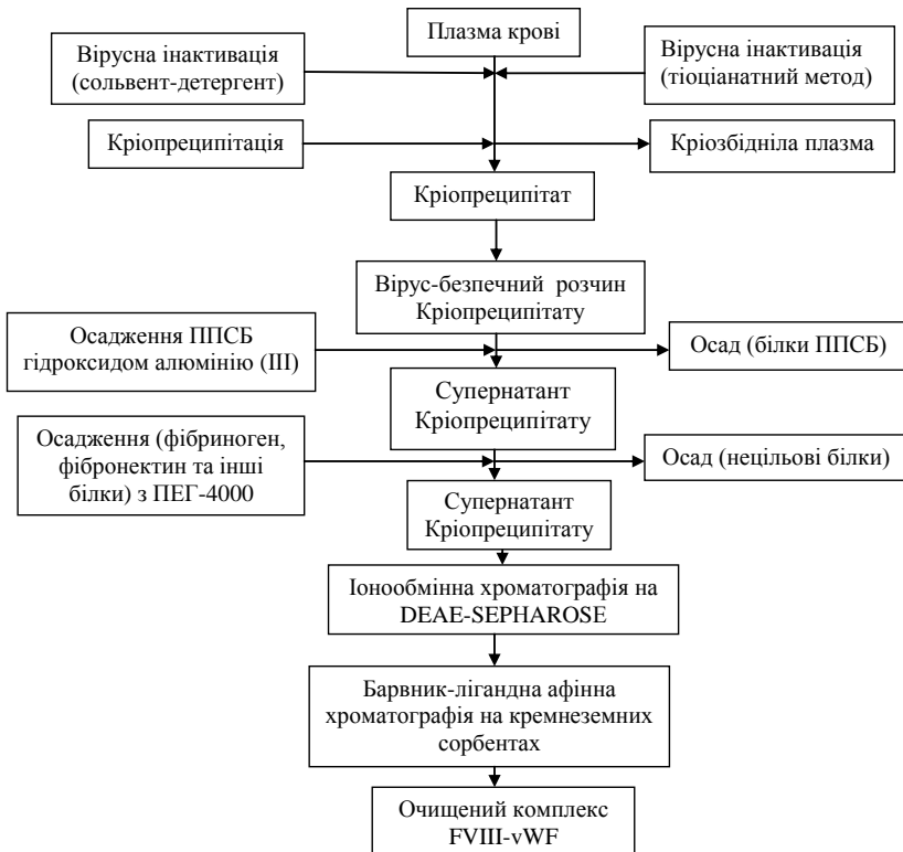
Рис. 3 Технологічна схема отримання FVIII із плазми крові
